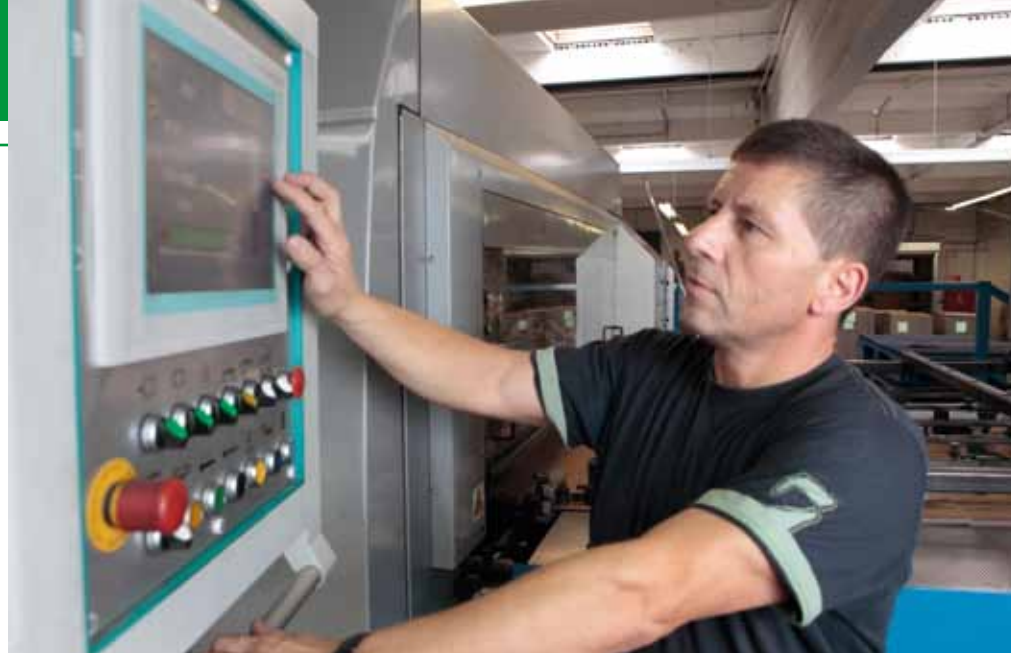
Produzione dei componenti degli espositori con fustellatrice piana
